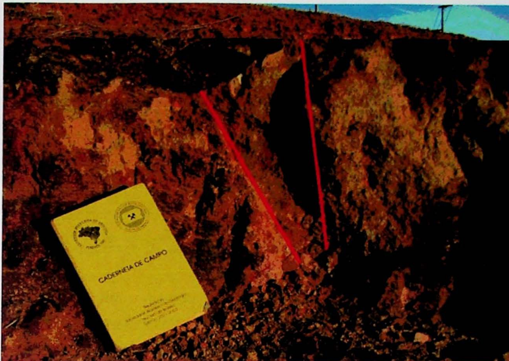
Figura 15. Fraturas conjugadas com bissetriz aguda inclinada em relação à normal (Local GR-07).
