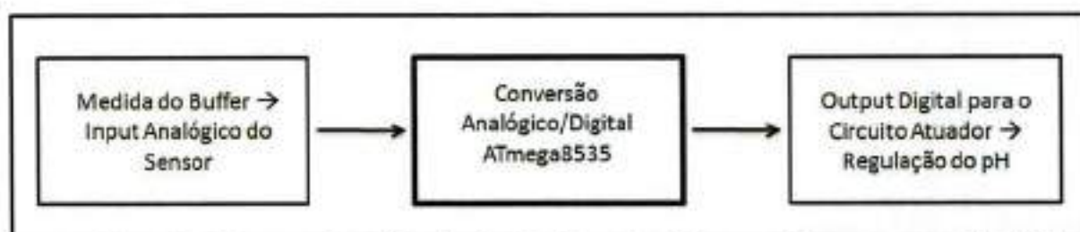
Figura 4 – Esquema simplificado do circuito controlador, com foco na conversão A/D dos sinais
