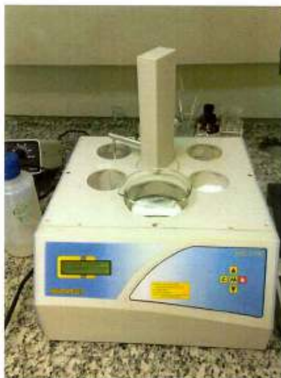
Figura 8 - Robô utilizado para automontagem
