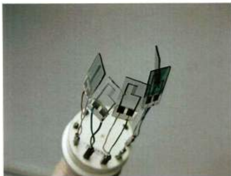
Figura 10 – Suporte com os sensores a serem testados, recobertos com PANI
