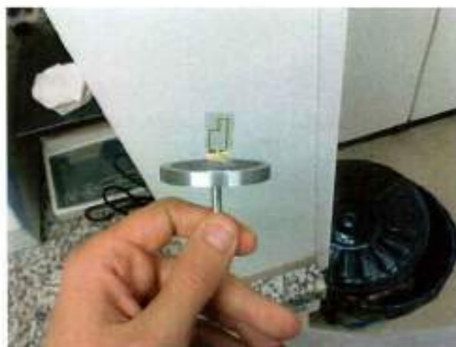
Figura 7 - Microeletrodo com geometria de 50 dígitos
