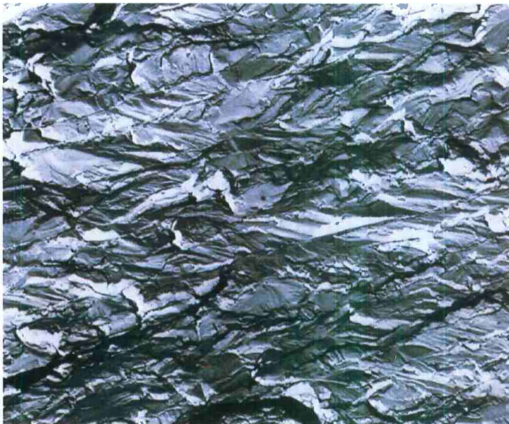
Figura 7: Micrografia (MEV) da fratura da liga Zr 2,5Nb pelo DHC
