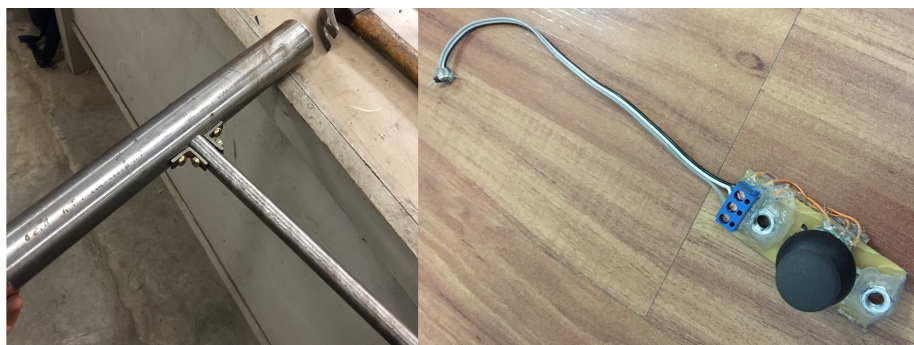
Figura 49: Apresentação do formato do guidão e do joystick embutido
