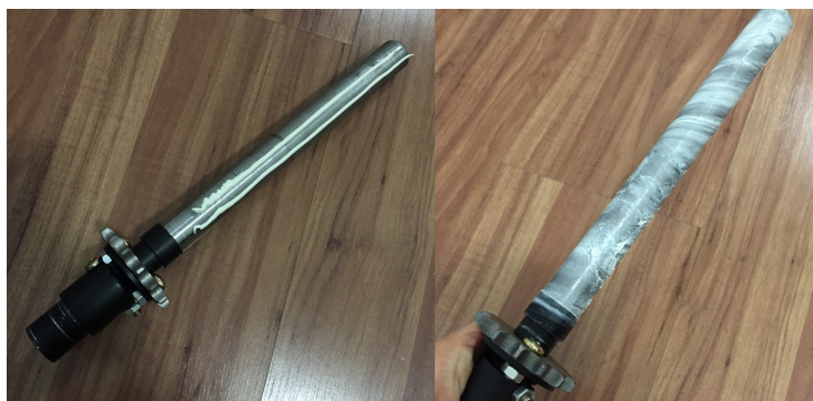
Figura 48: Graxa aplicada sobre os eixos do sistema
