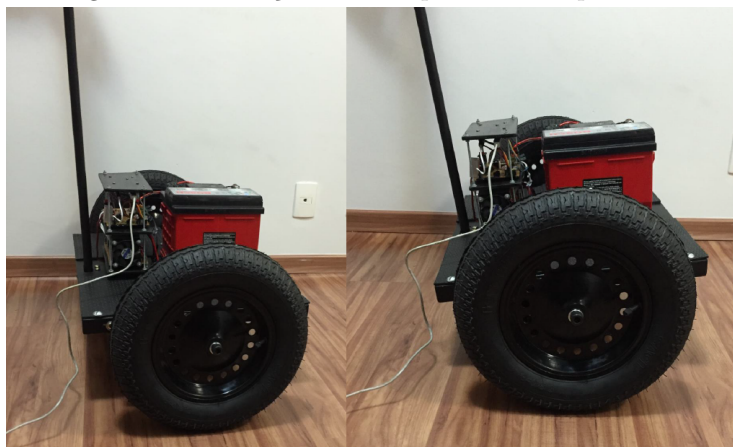
Figura 54: Disposição paralela ao chão e de equilíbrio natural
