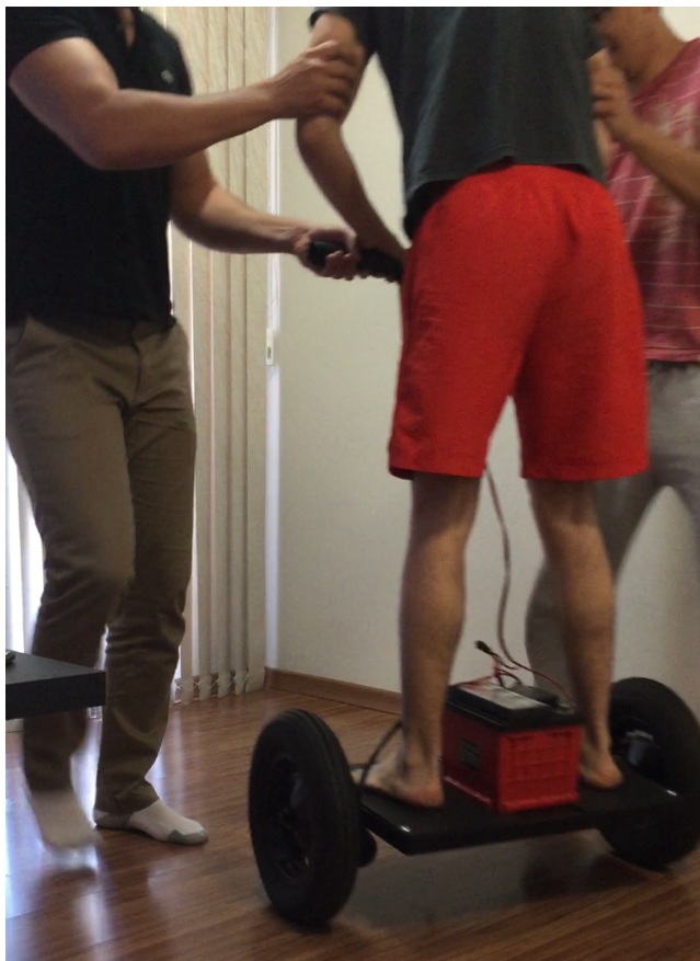
Figura 52: Teste de suporte de uma pessoa sobre o sistema
