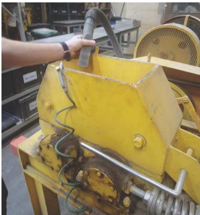
Figura 43 – Detalhe da colocação do captor no britador de rolos.
