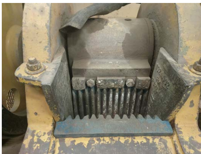
Figura 42 – Detalhe da colocação do captor no britador de mandíbulas.
