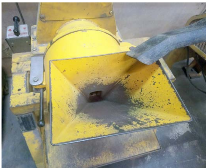
Figura 44 – Detalhe da colocação do captor no moinho de discos.
