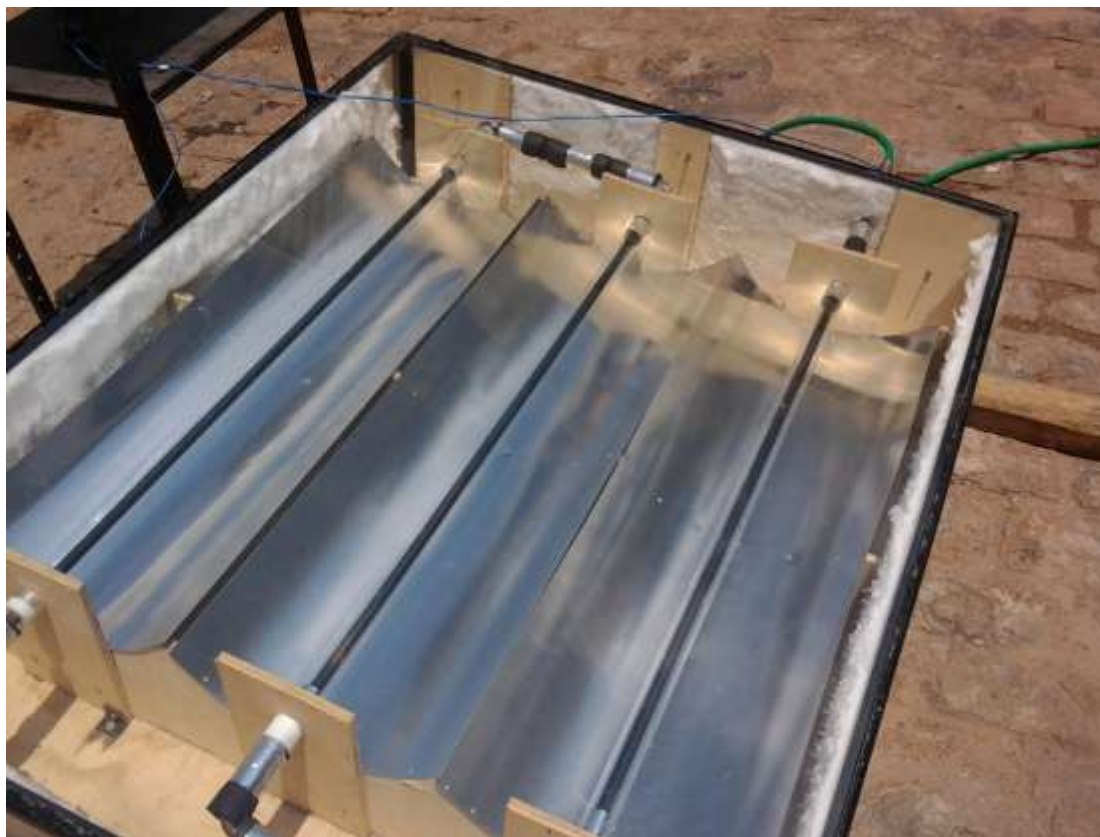
Figura 40 - Coletor solar em funcionamento
