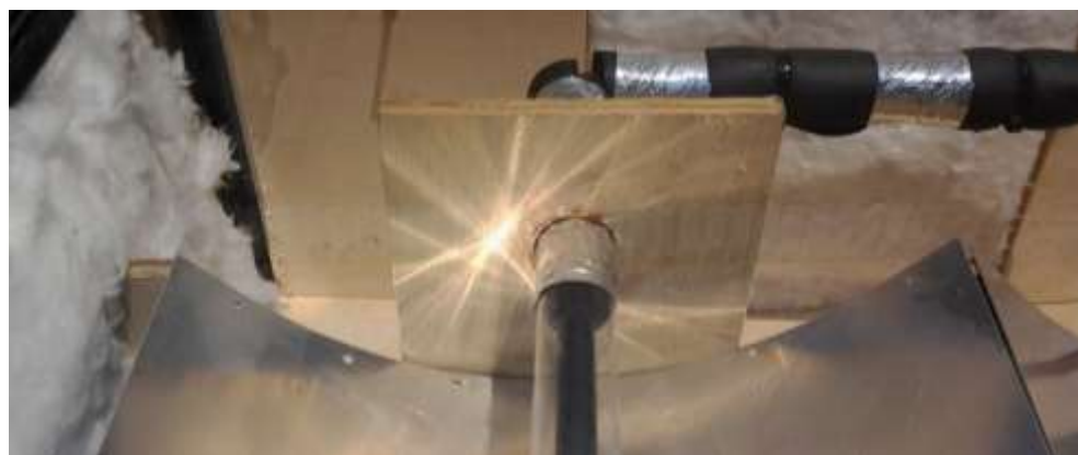
Figura 39 – Concentração fora do foco, antes do ajuste da inclinação do coletor
