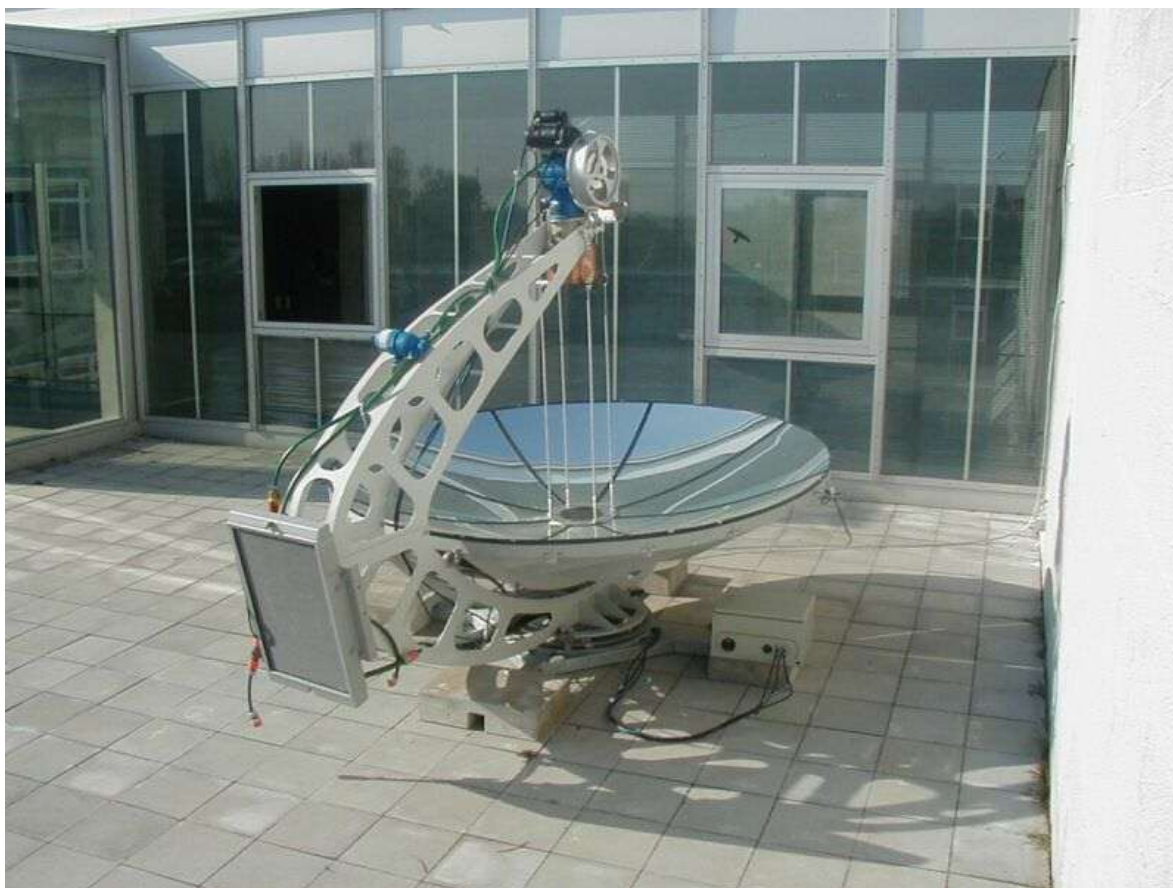
Figura 7 - Concentrador parabolóide (Fonte: SolarPACES)
