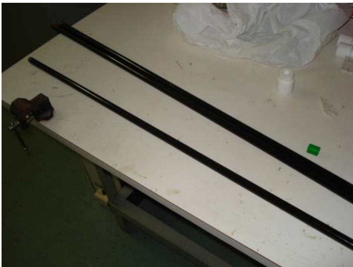
Figura 22 - Tubos de cobre pintados de preto
