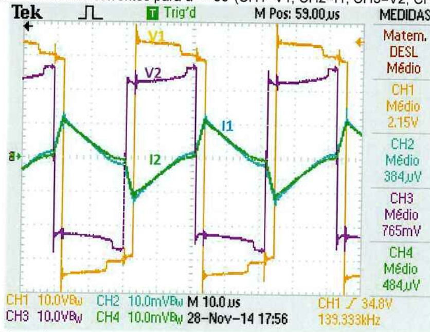
Figura 26 - Tensões e correntes para \alpha = -30^\circ (CH1=V1; CH2=I1; CH3=V2; CH4=I2)
