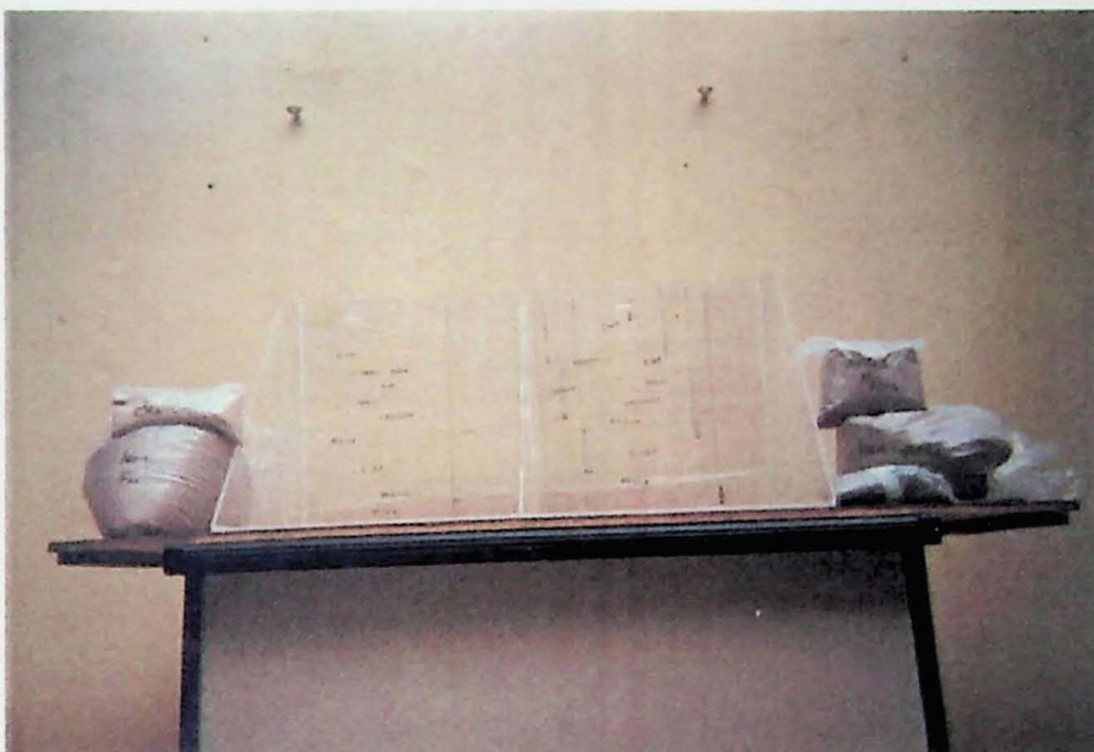
Foto 01: Caixa de acrílico com as camadas desenhadas segundo o modelo numérico preliminar e os materiais de preenchimento da caixa já peneirados.
