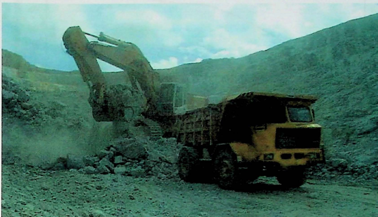
Foto 1. Retro-escavadeira Liebherr carregando caminhão Random com caçamba para 30 toneladas.
