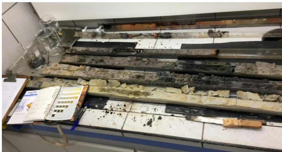
Figura 16 – Abertura de amostrador e descrição tátil-visual do solo coletado
