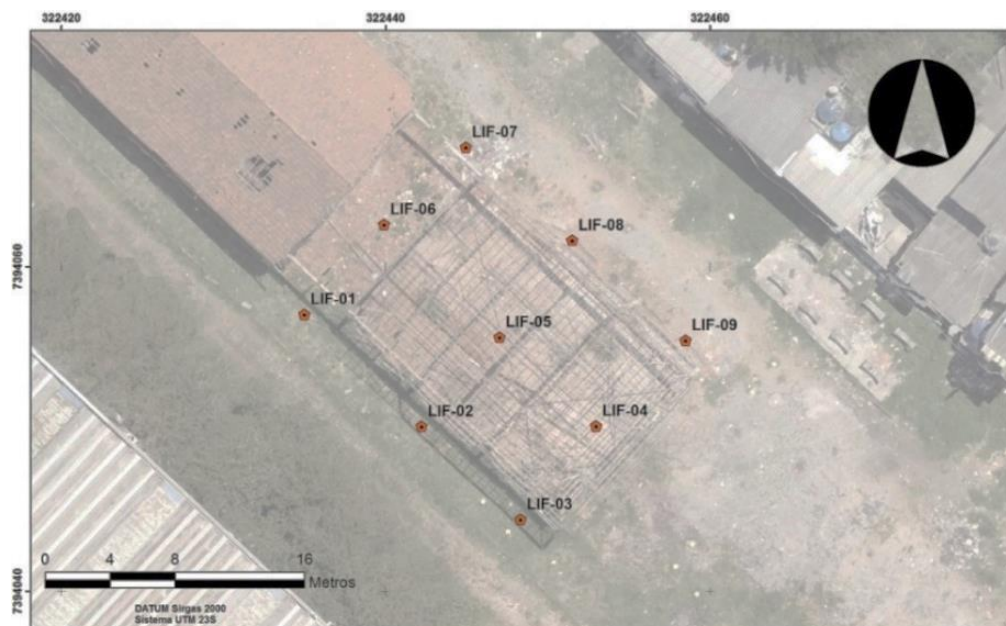
Figura 17 – Localização dos pontos de sondagem por cravação direta para aplicação da técnica LIF.
