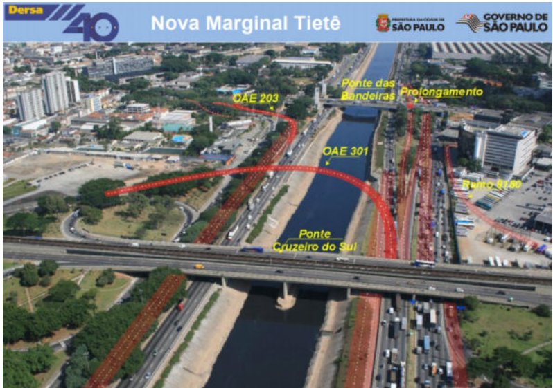
Imagem 10: Ilustração das obras de ampliação da Marginal Tietê, em trecho próximo ao Anhembi. Percebe-se a inclusão de pistas expressas ao lado do rio e nos canteiros centrais e de pontes e acessos exclusivos para veículos. Fonte: DERSA, 2009.
