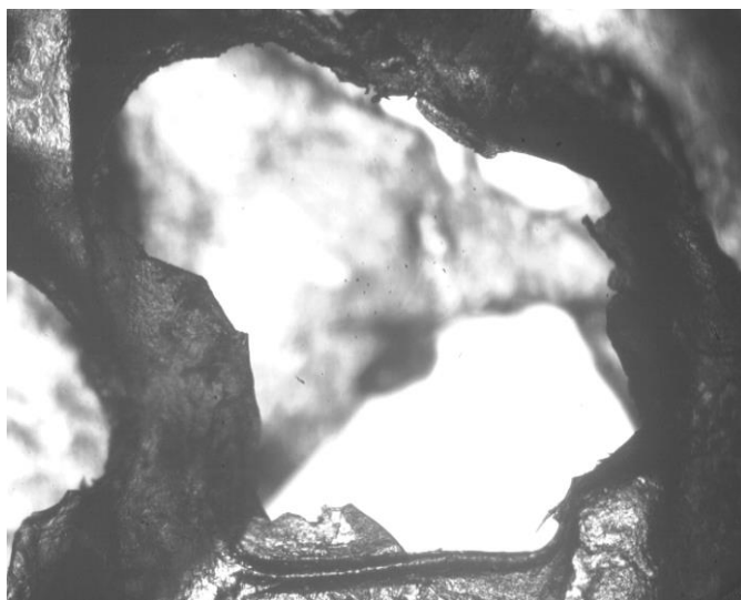
Figura 10 - Micrografia óptica do compósito formado pela incorporação de TPS na fase contínua de celulose regenerada. 32x
