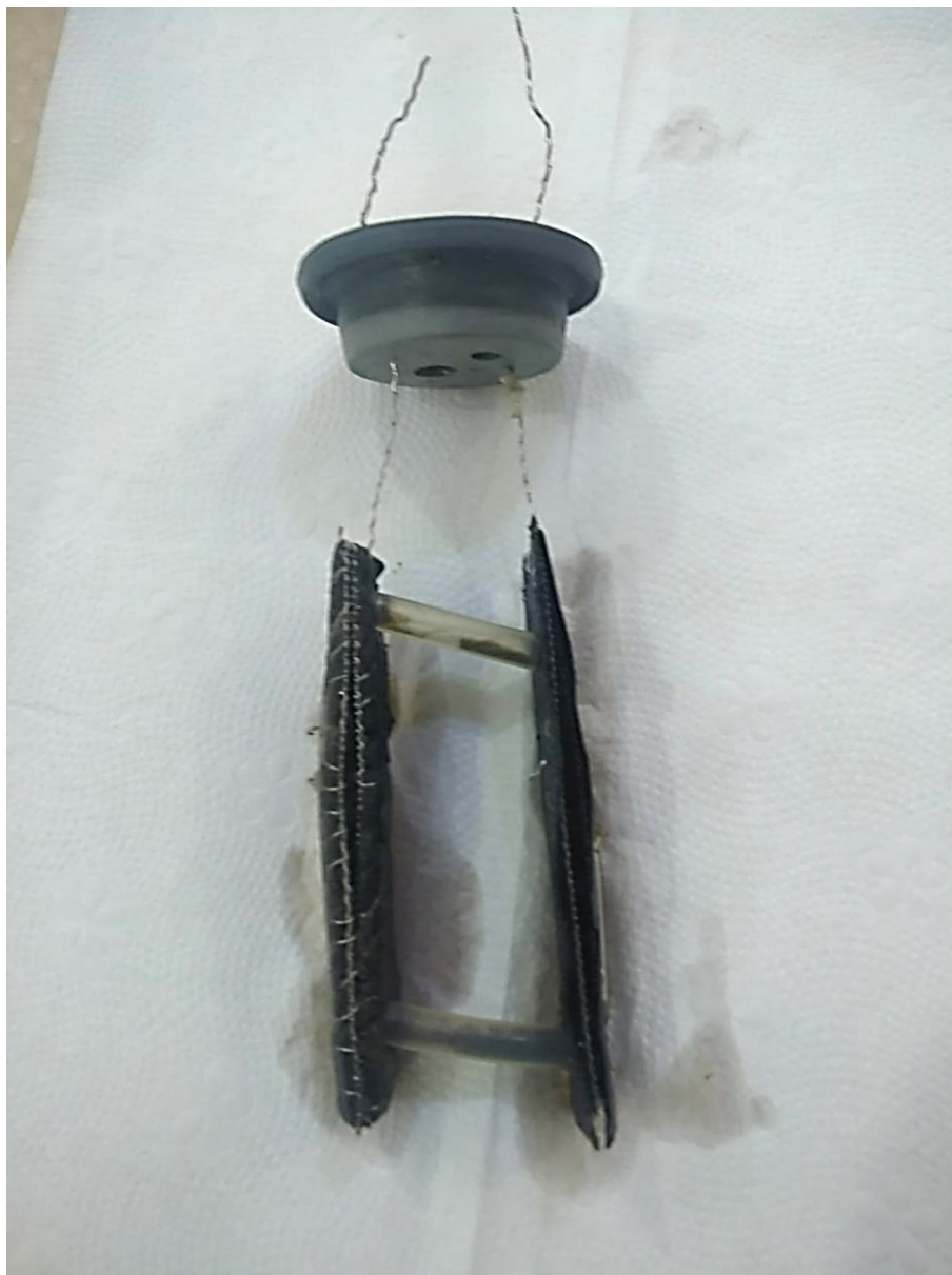
Figura 6 - Eletrodos montados em configuração de operação
