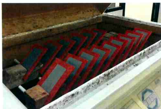
Figura 28 - Foto dos corpos de prova dentro da câmara da névoa salina.
