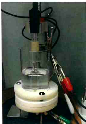
Figura 26 – Célula de três eletrodos utilizada para avaliar a cinética de liberação do inibidor de corrosão dodecilamina carregado na haloisita
