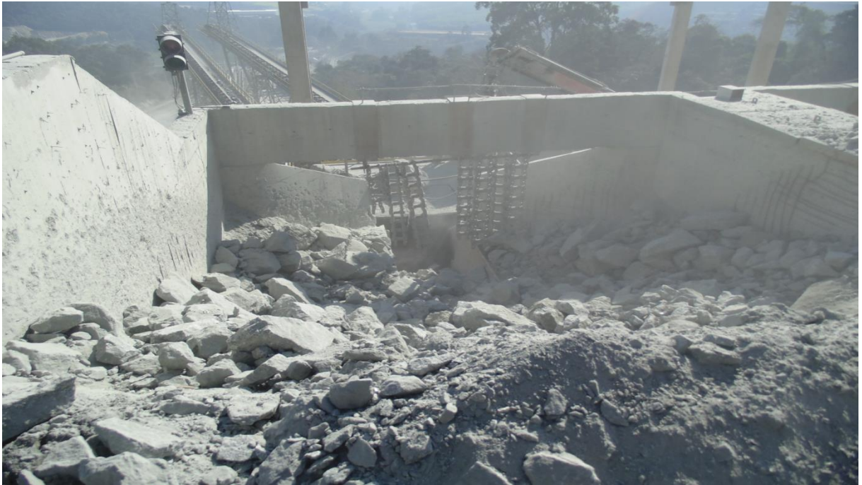
Figura 14. Minério bruto em processo de britagem primaria.
