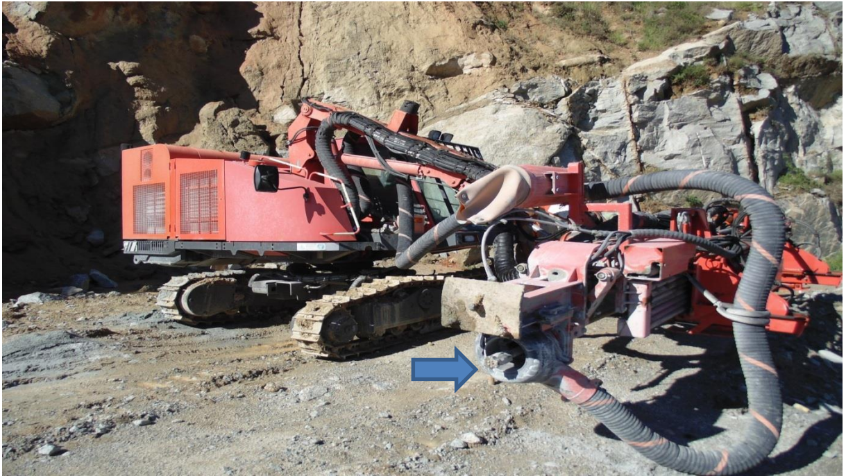
Figura 29. Máquina perfuratriz com coletor de poeira.
