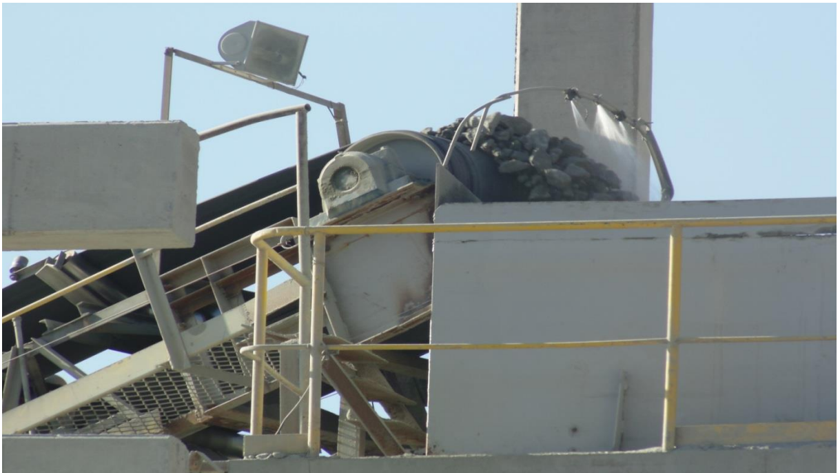
Figura 31. Sistema de umectação do material para rebitagem 1.
