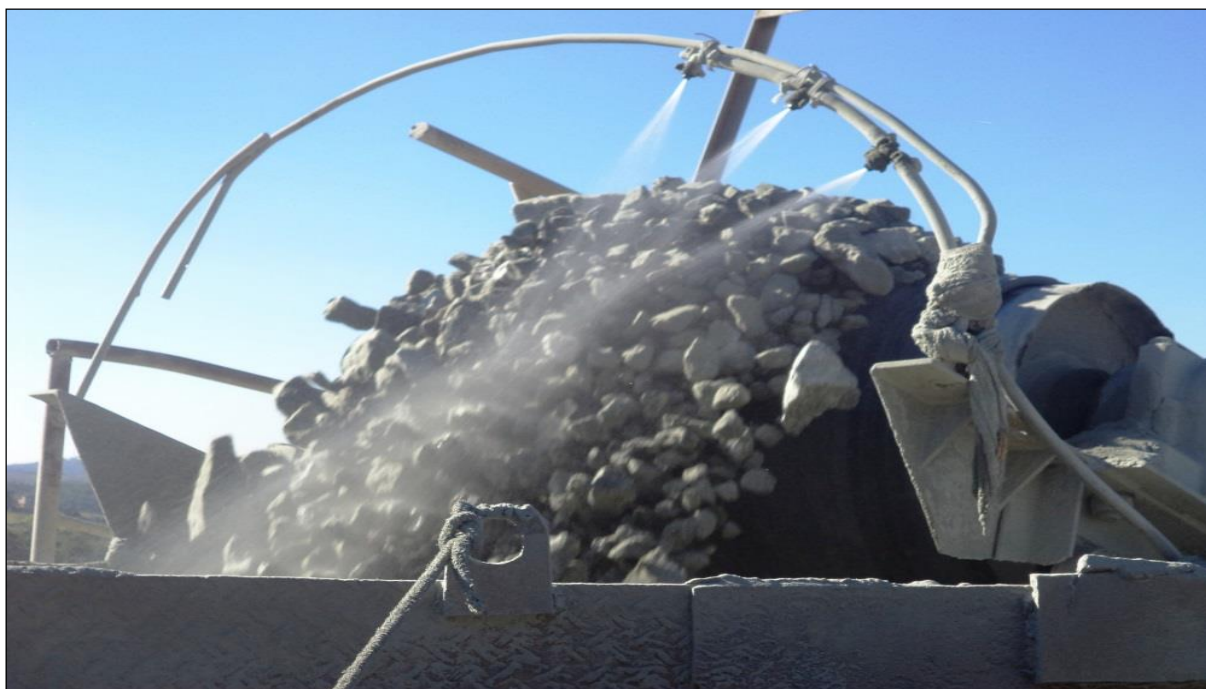
Figura 32. Sistema de umectação do material para rebritagem 2.
