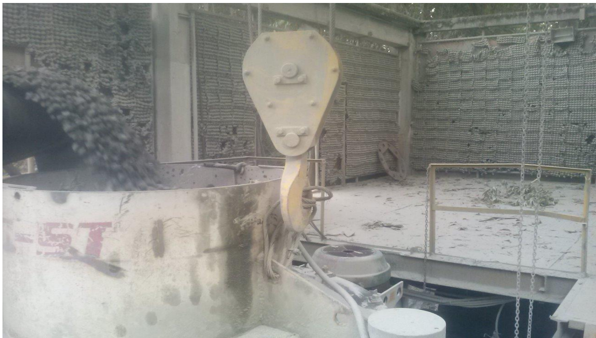
Figura 37. Emborrachamento e enclausuramento britador secundário.
