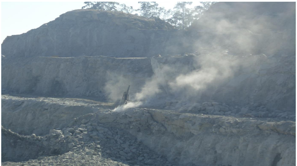
Figura 25. Emissão de material particulado produzido pela ação da perfuratriz.
