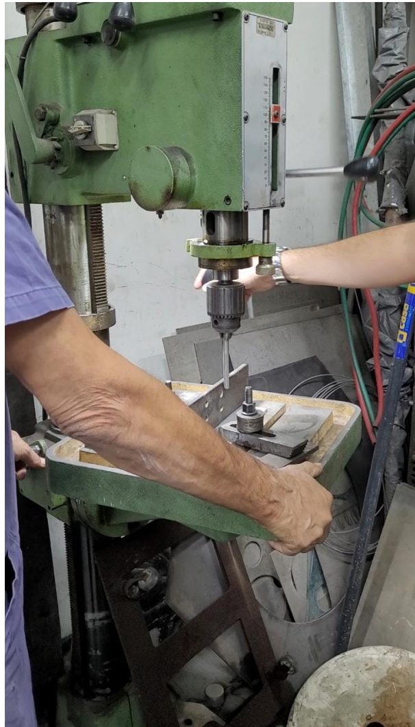
Figura 4.4: Início do teste a partir da movimentação da máquina para estabelecer contato entre as ligas. [Fonte: De autoria própria.]
