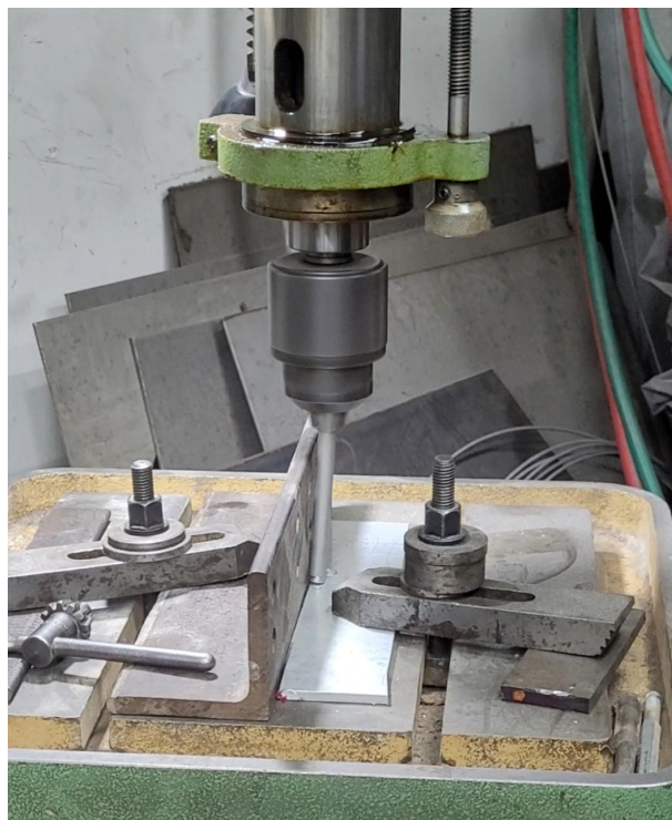
Figura 4.6: Outra vista do desalinhamento no elemento consumível. [Fonte: De autoria própria.]
