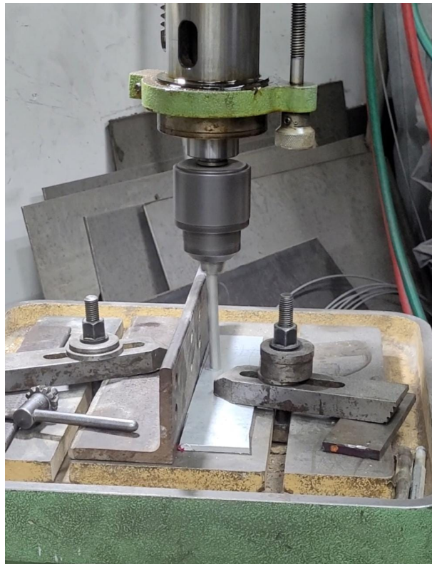
Figura 4.5: No momento de contato, é possível perceber desalinhamento e oscilações no elemento consumível. [Fonte: De autoria própria.]
