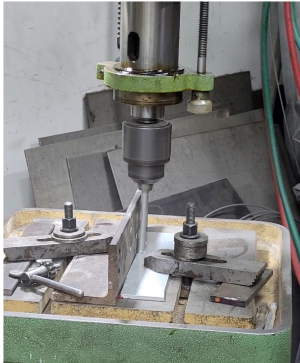
Figura 4.7: Segunda tentativa para o teste. O elemento consumível é retirado, a máquina é regulada novamente, mas o desalinhamento continua presente. [Fonte: De autoria própria.]
