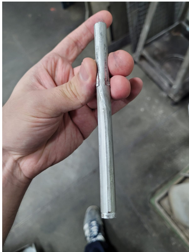
Figura 4.10: Aspecto estrutural relacionado ao processo de torção que o elemento acabou sofrendo no teste. [Fonte: De autoria própria.]
