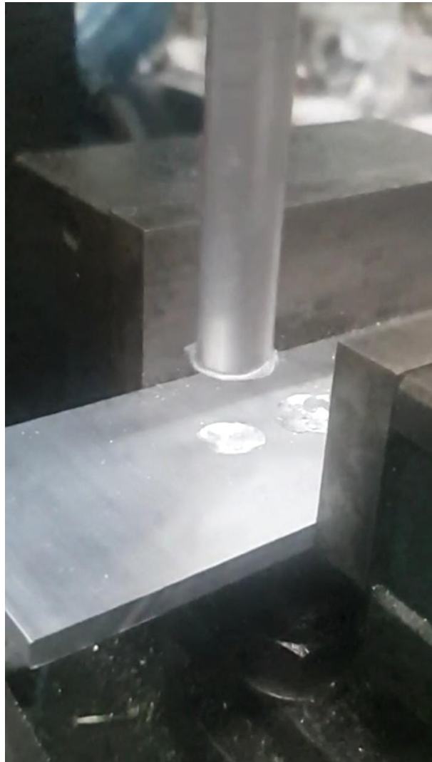
Figura 4.12: Formação inicial da região de rebarba. É o indicativo do processo de DSF. [Fonte: De autoria própria.]
