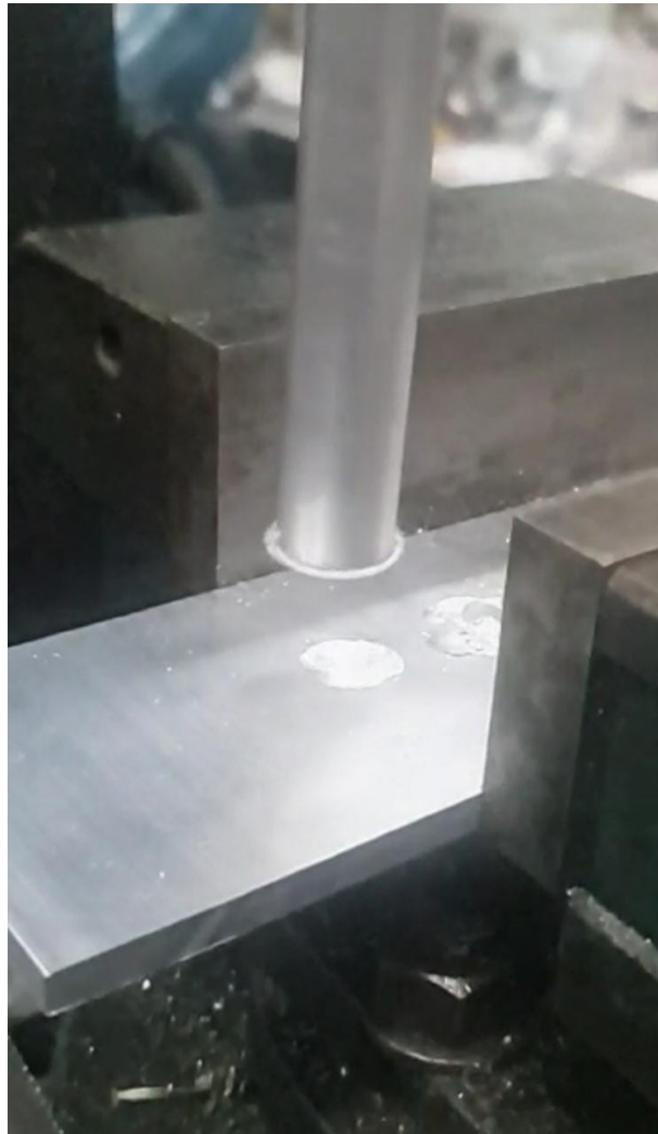
Figura 4.11: Marcas no metal base mostram o processo de tentativa de deposição em pontos distintos. [Fonte: De autoria própria.]
