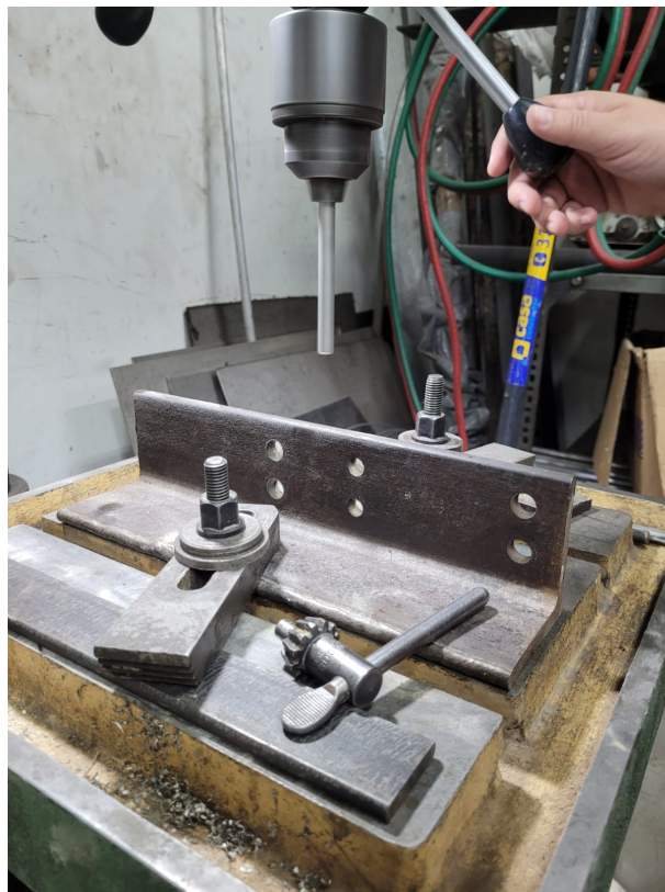
Figura 4.3: Elemento consumível e apoios utilizados para garantir que o metal base permaneça estático. [Fonte: De autoria própria.]
