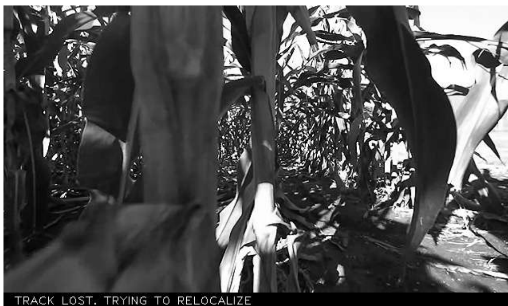
Figura 11 – Imagem de debug quando há falha do algoritmo. Nesse caso, há colisão do robô com a plantação
