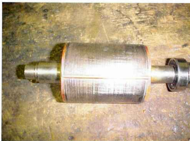
Fig. 39 - "Rotor" com a barra de cobre (vista superior)
