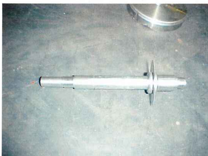
Fig. 26 - Eixo usinado, com anéis de retenção
