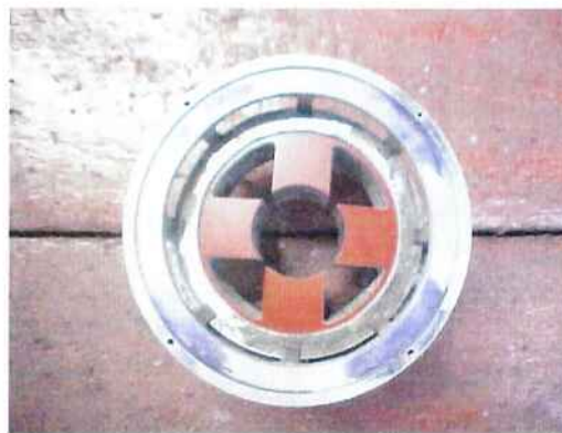
Fig. 30 - Núcleo magnético “estatórico” prensado na carcaça (vista superior)
