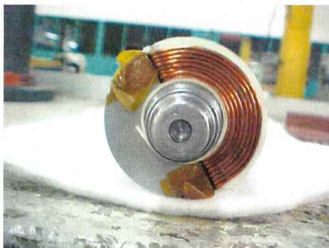
Fig. 34 - Enrolamento da bobina "rotórica" em curto
