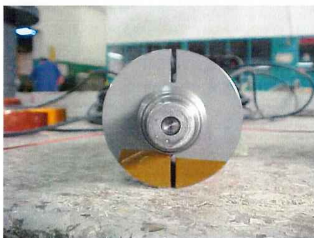
Fig. 32 - Núcleo magnético “rotórico” prensado no eixo (vista frontal)
