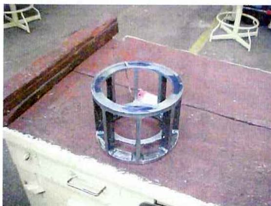
Fig. 28 - Carcaça com anel retentor das chapas “estatóricas”
