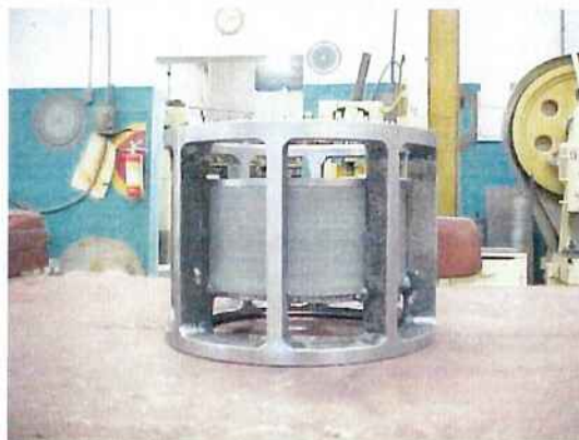
Fig. 29 - Núcleo magnético “estatórico” prensado na carcaça (vista lateral)
