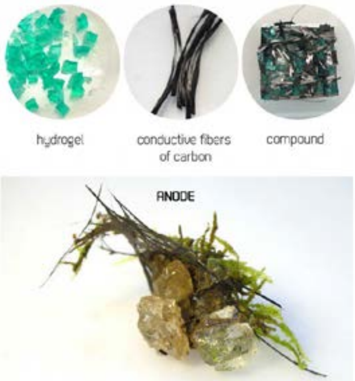
► Figura 34. Elementos do composto anódico para sistema bioelétrico. (Fonte: MossVoltaics/IAAC)
