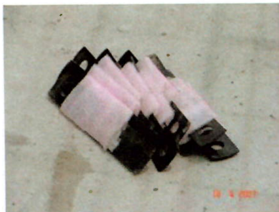
Figura 12: Camisas nas peças de travamento dos moldes Fonte: Homex Construtora
