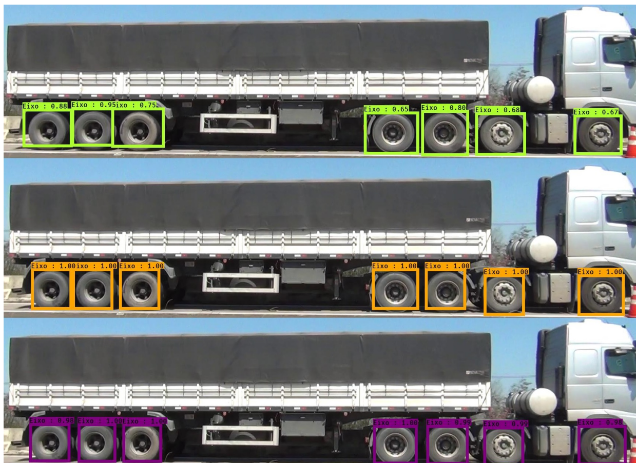
Figura 27 – Comparação dos graus de confiança das detecções; YOLO, Faster R-CNN e SSD respectivamente.
