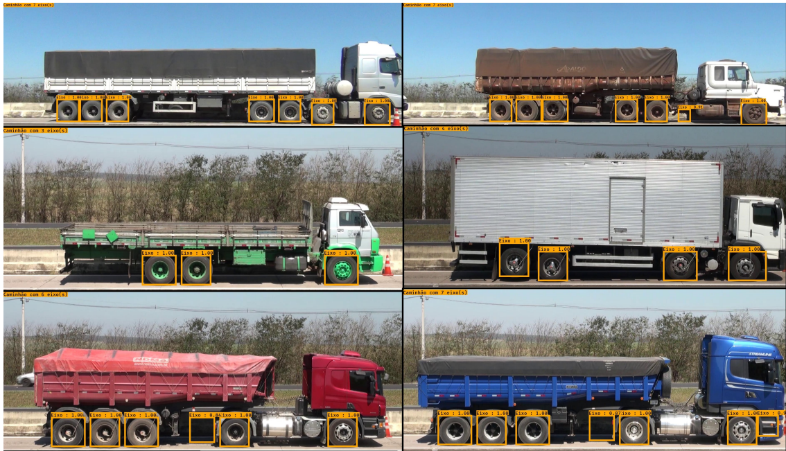
Figura 25 – Exemplos de detecções Faster R-CNN
