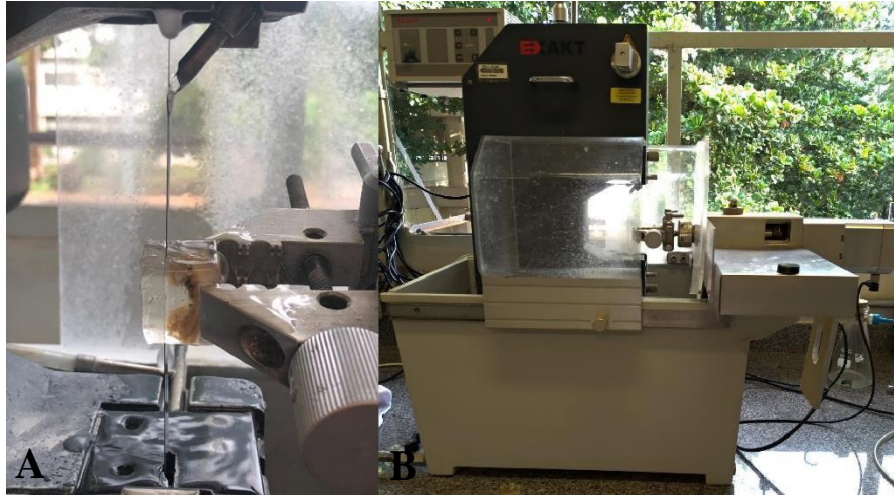
Figura 6 - A e B. Exemplo de corte trans axial realizado no equipamento Exakt (Apparatebau, Norderstedt, Alemanha), no laboratório de Histologia da FORP-USP.
