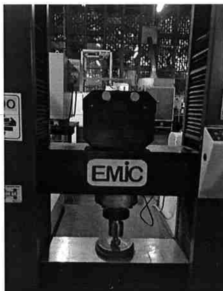
Figura 6 - Prensagem dos briquetes na máquina universal de ensaios EMIC
