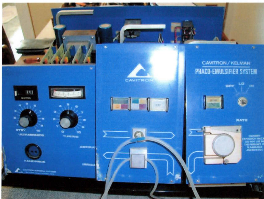
Figura 7-1- Facoemulsificador da marca Cavitron Kelman
