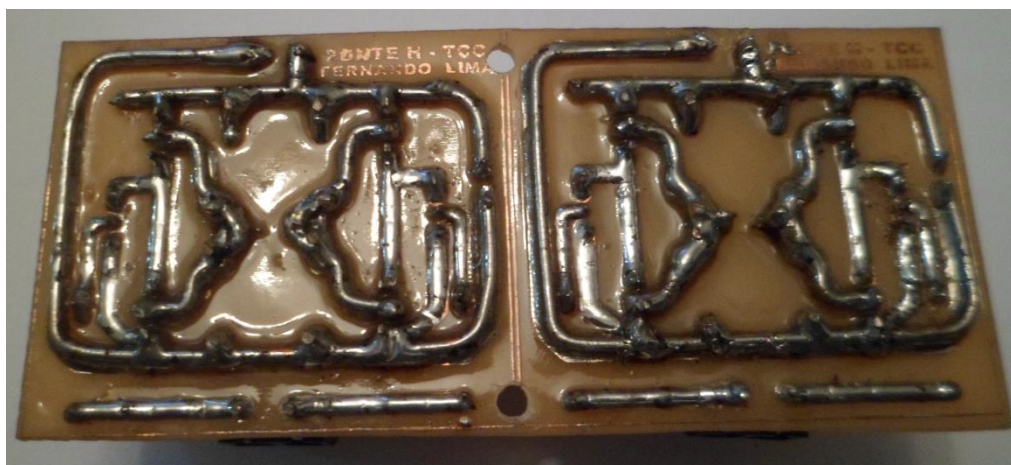
Figura 3.37 – PCI da Ponte H – Vista de baixo
