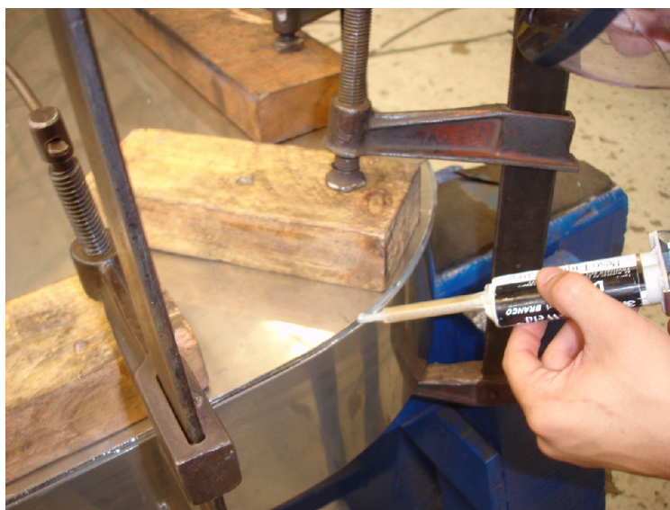
Figura 25: Detalhe da cola estrutural após aplicação.
