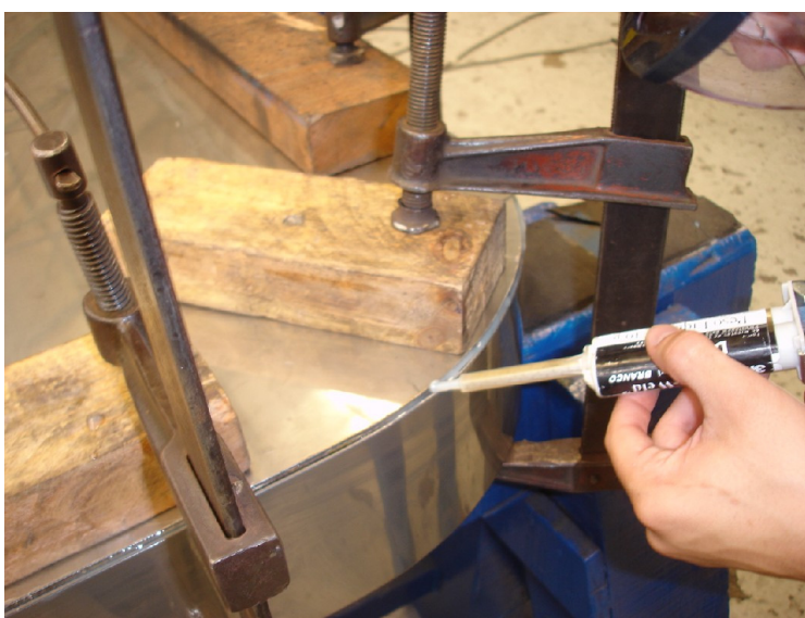
Figura 24: Aplicação da cola estrutural DP 460.
