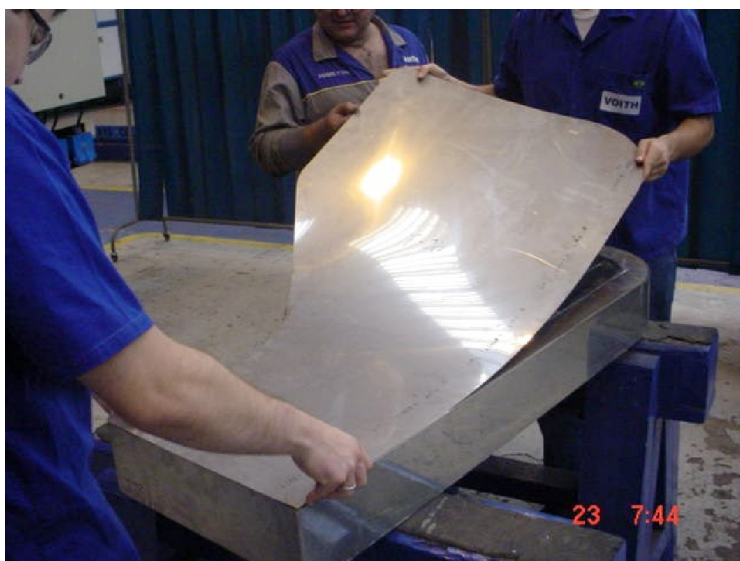
Figura 23: Aplicação do revestimento.
