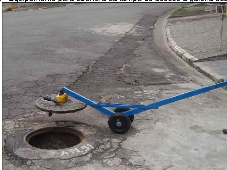
Figura 66 - Equipamento para abertura da tampa de acesso à galeria subterrânea
