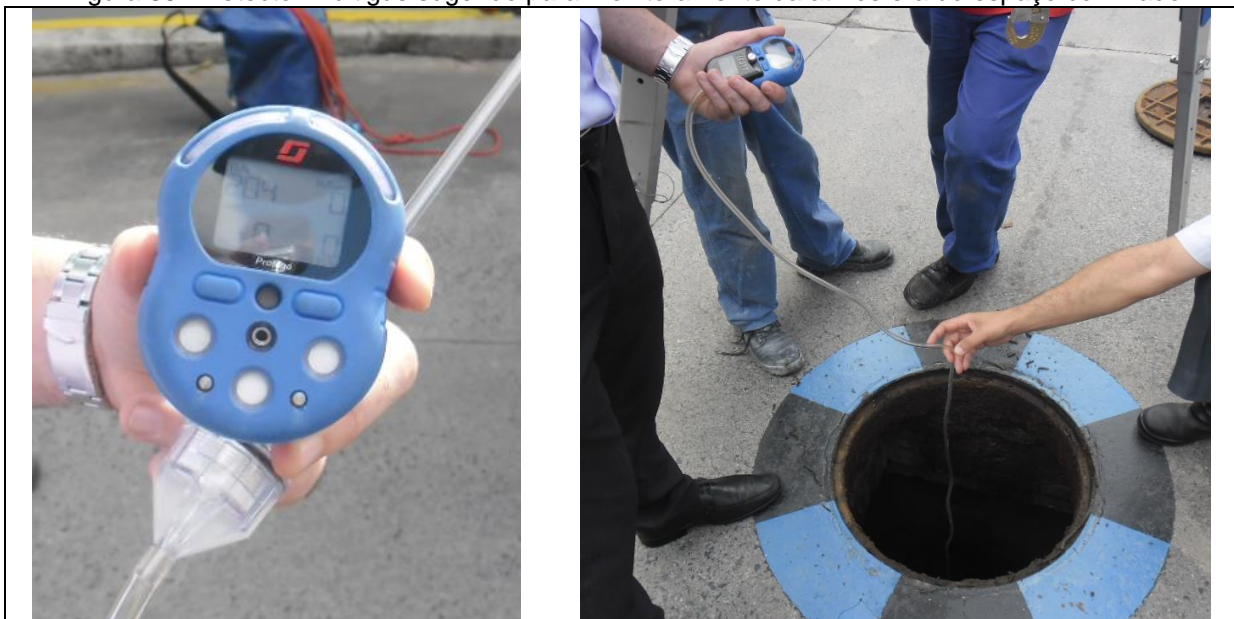
Figura 65 - Detector multigás sugerido para monitoramento da atmosfera do espaço confinado
