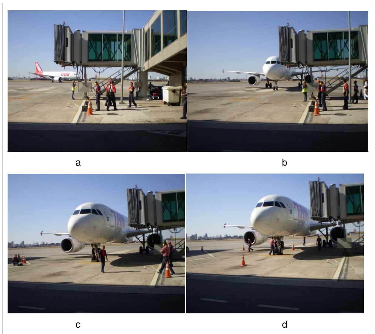
Figura 10 - a) Preparação da equipe de solo para a chegada da aeronave; b) Aeronave se aproximando do ponto de parada; c) Aeronave calçada após a sua parada; d) Inserção dos cones de balizamento Fonte: Arquivo Pessoal
