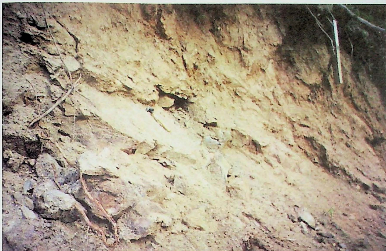
Foto 4 - Escorregamento Estruturado em Rocha
