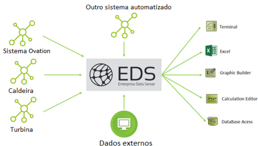
Figura 13: Representação esquemática do EDS com algumas de suas principais ferramentas.
