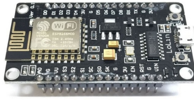
Figura 9 – Placa de desenvolvimento LoLin com módulo Wi-Fi® ESP8266
