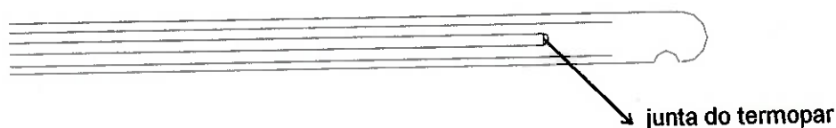
Fig. 4 : Parte cerâmica do pirômetro
