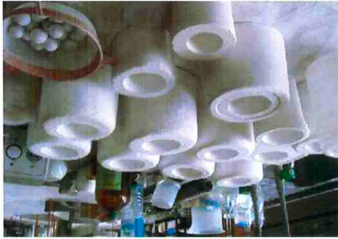
Figura 5: Moldes fabricados em gesso para a fabricação de cadinhos de alumina pelo processo de colagem
