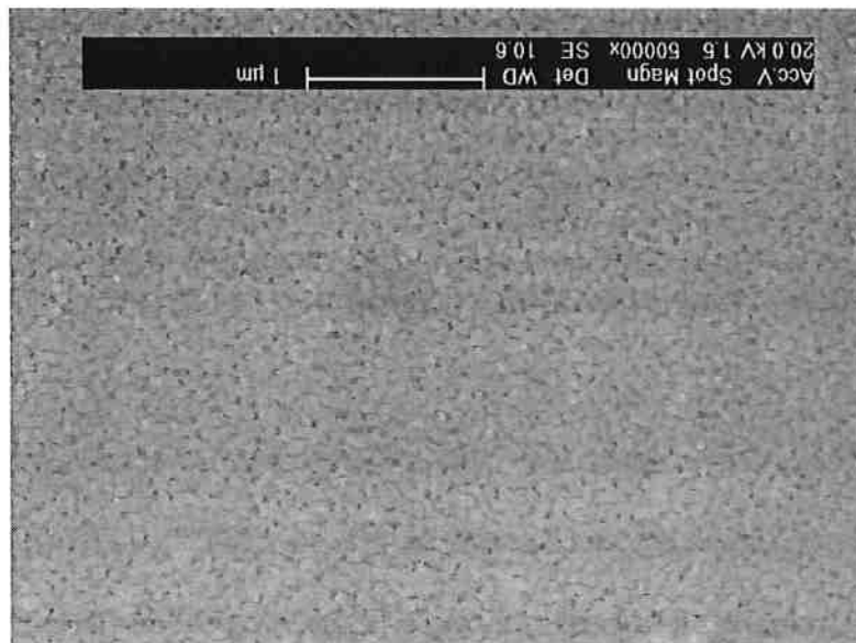
Figura 24: Imagem de uma superfície de fratura de um vidro de basalto tratado a 880°C durante 240 minutos, com ataque de solução de 5% HF por 25 segundos.
