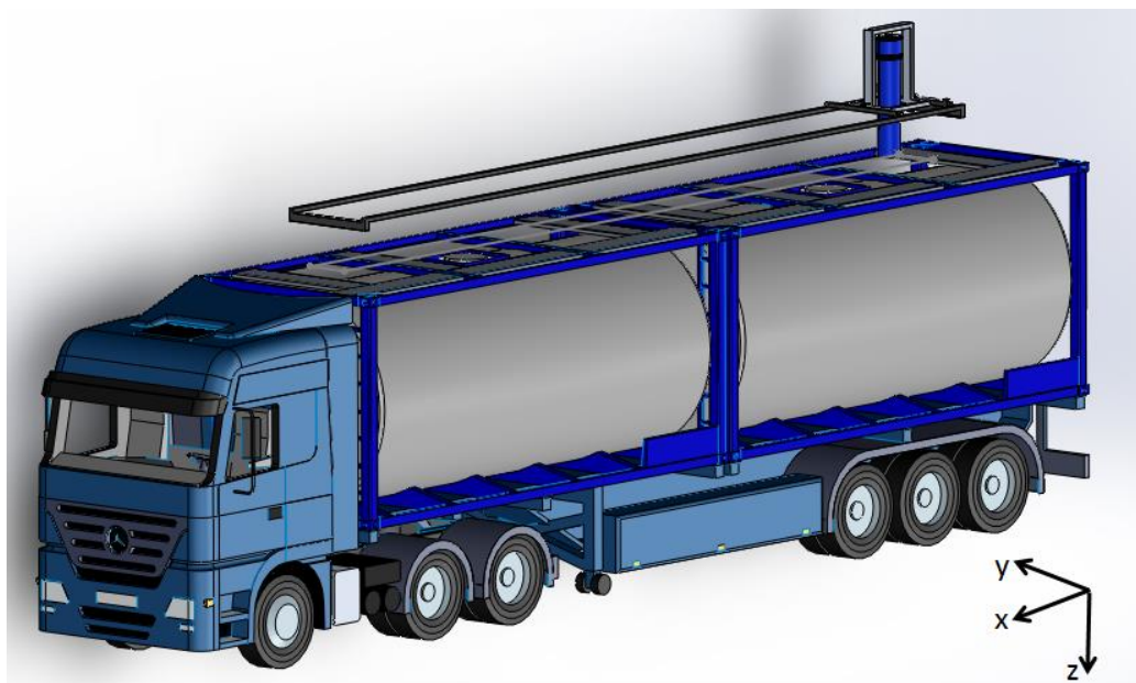
Figura 33: Eixos Adotados Para Posicionamento do Manipulador [32]
