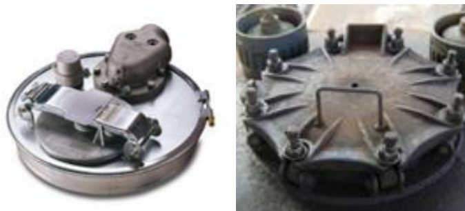
Figura 35: Mecanismos de Abertura de Tampas de Autotanques [33]
