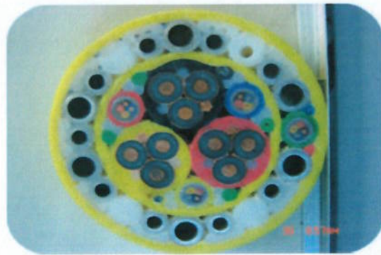
Figura 6: Umbilical de seção-cruzada (Eckerty et al, 2010)
