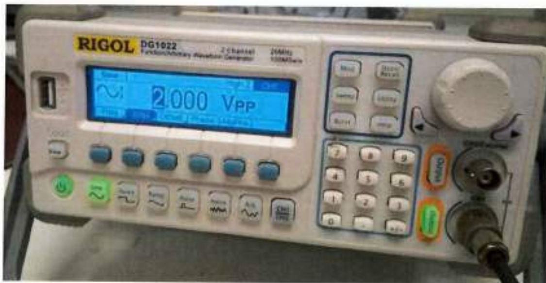
Figura 39 - Senóide de 2Vpp e 60Hz como entrada teste
