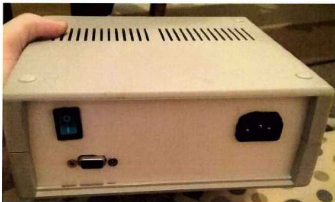
Figura 51 - Encapsulamento com chave liga/desliga, entrada para cabo de força 110V e entrada para o transistor
