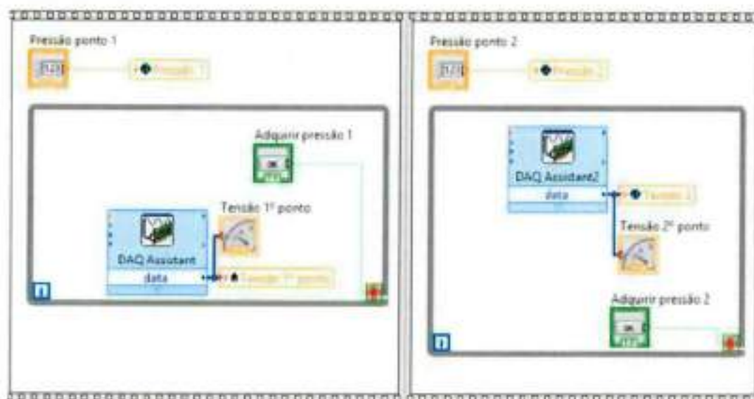
Figura 28 – Implementação lógica da etapa de aquisição dos sinais de calibração
