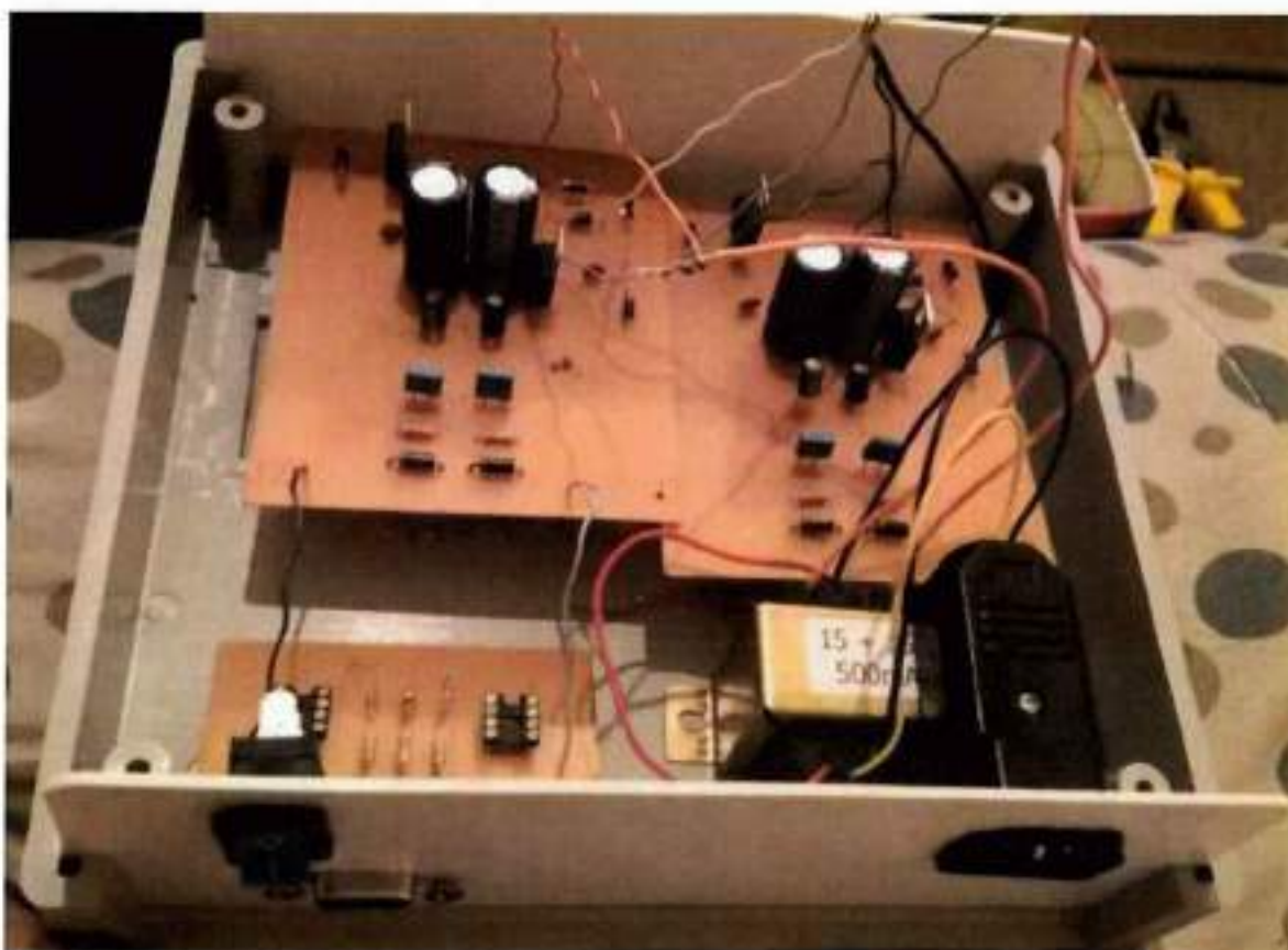
Figura 52 - Exemplo dos componentes e placas dispostos no encapsulamento
