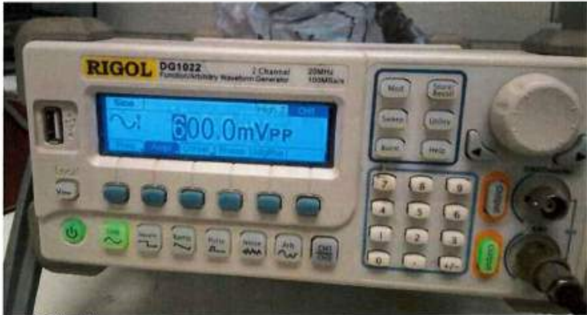
Figura 37 - Senóide de 600mVpp e frequência 60Hz
