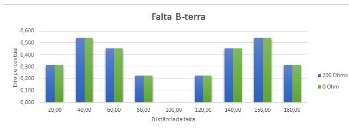
Figura 30 – Comparação entre as diferentes resistências de faltas na estimativa de distância em faltas fase B-terra
