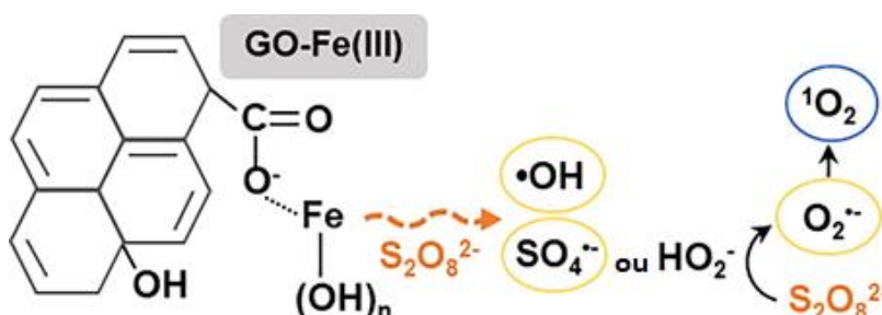
Figura 14 – Mecanismo de ativação do persulfato a partir de óxidos de grafeno adsorvidos com sais de ferro.
