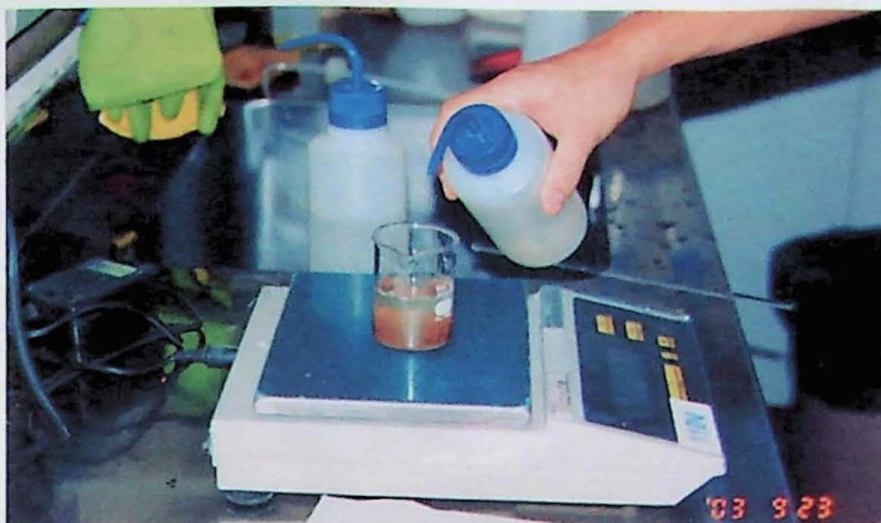
Foto 16: Adição de 50 mL de água destilada a 10 g de solo.
