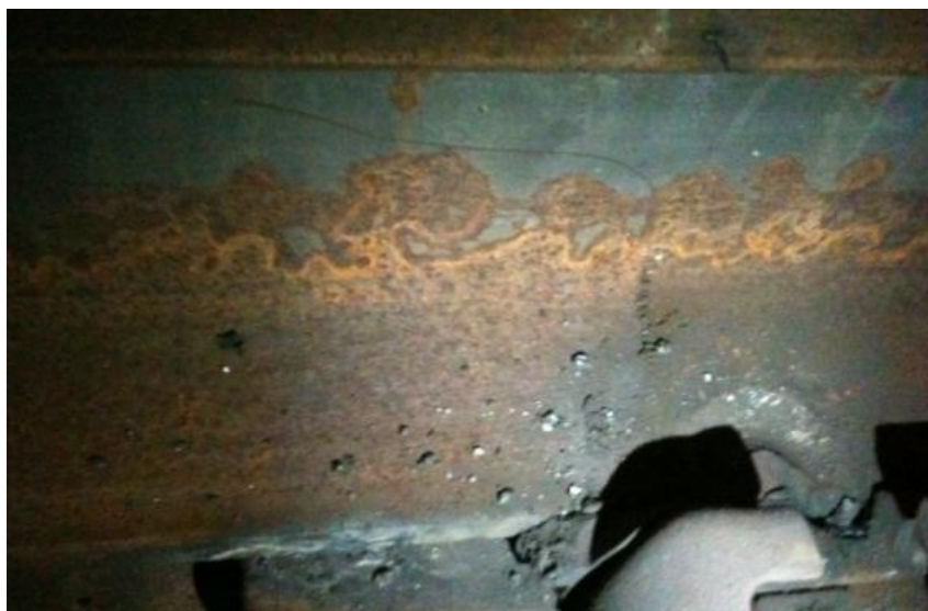
Figura 3 – Trinca Trilho. Fonte: O próprio autor, 2016.
