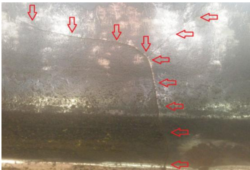
Figura 4 – Trinca no trilho devido a corrente de fuga. Fonte: O próprio autor, 2016.
