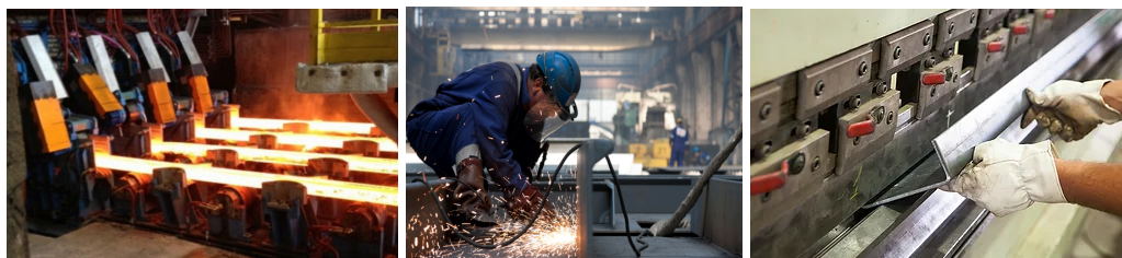
Figura 4 - Laminação, soldagem e conformação a frio de perfis metálicos
