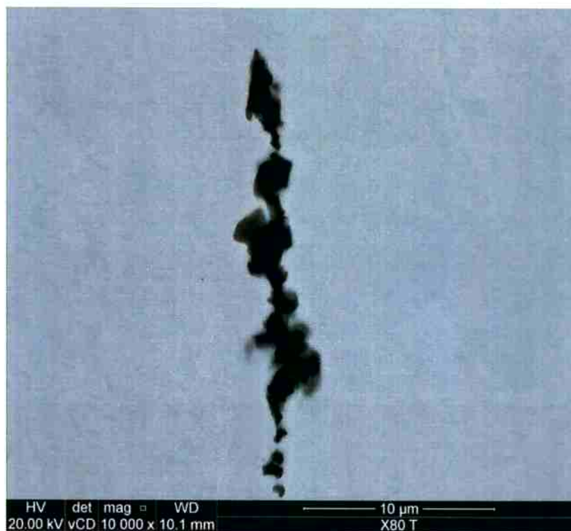
Figura 23 – Imagem de elétrons retroespalhados em MEV de uma inclusão na amostra de aço X80. Aumento de 10.000X.
