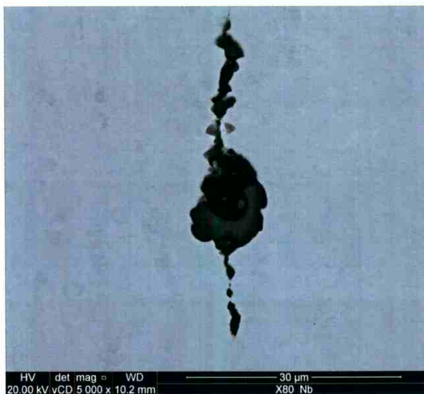
Figura 27 – Imagem de elétrons retroespalhados em MEV de uma inclusão na amostra de aço X80 0,1Nb. Aumento de 5.000X.
