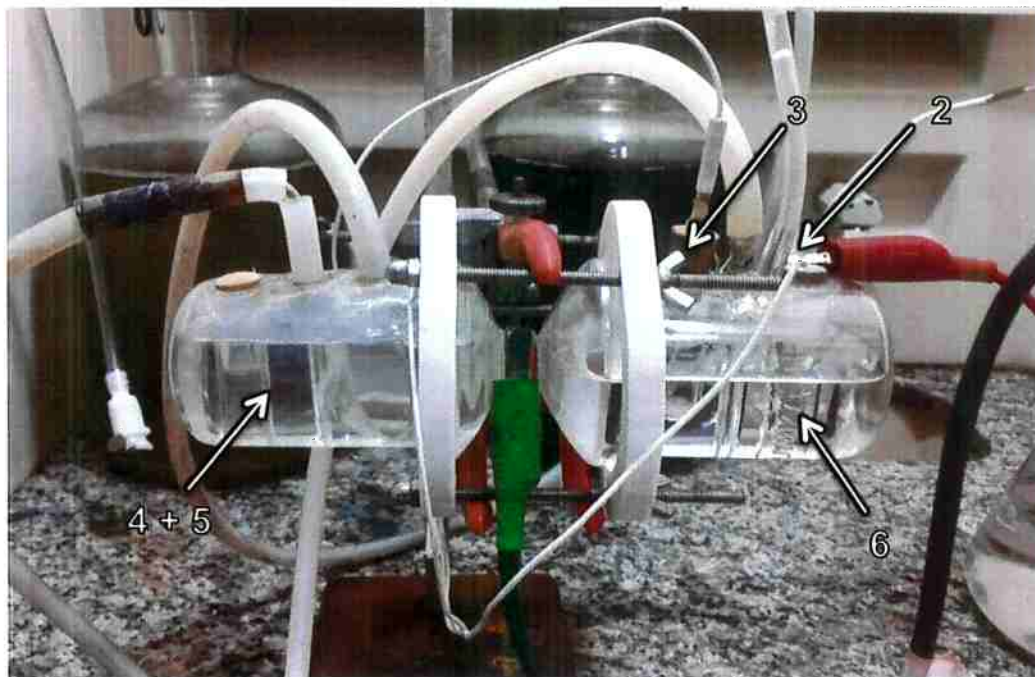
Figura 11 - Célula de permeabilidade de hidrogênio Devanathan-Stachursky.
