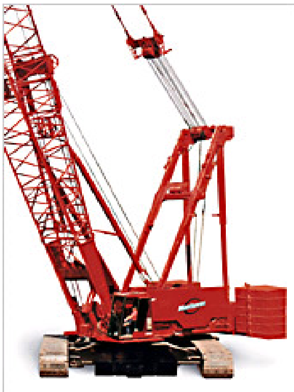
Figura 36: Guindaste móvel sobre esteira Manitowoc 2250
