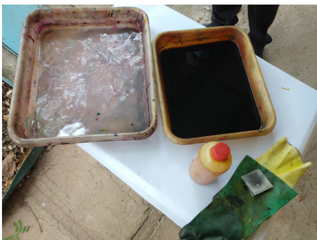
Figura 7: Bacia com mordente para banho da chapa de cobre, luvas e pinça.
