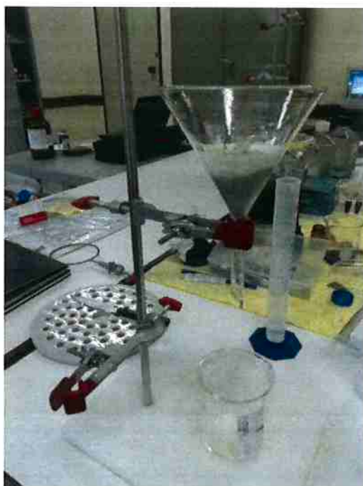
Figura 6: Preparação da solução de GO
