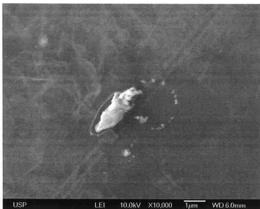
Figura 21: Micrografia do filme de 1GO:0,1Ag de 1 camada com 10000 vezes de aumento
