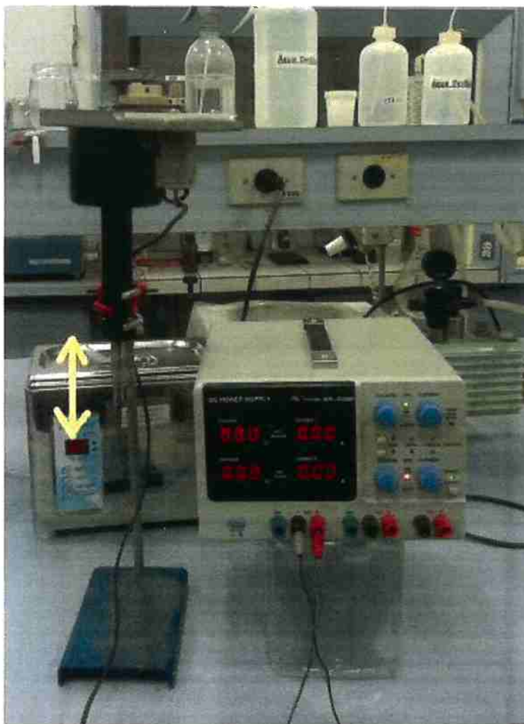
Figura 8: Aparelho de dip coating montado para trabalho
