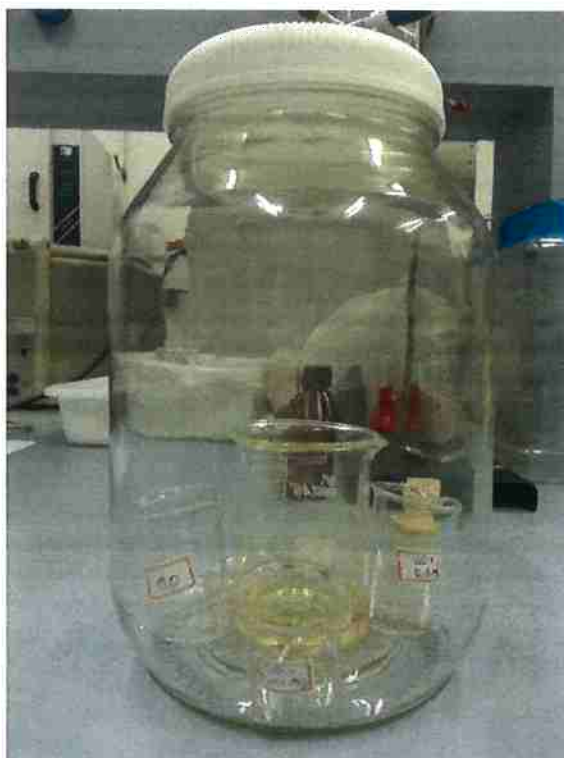
Figura 10: Recipiente no qual os filmes estão expostos ao vapor de HI
