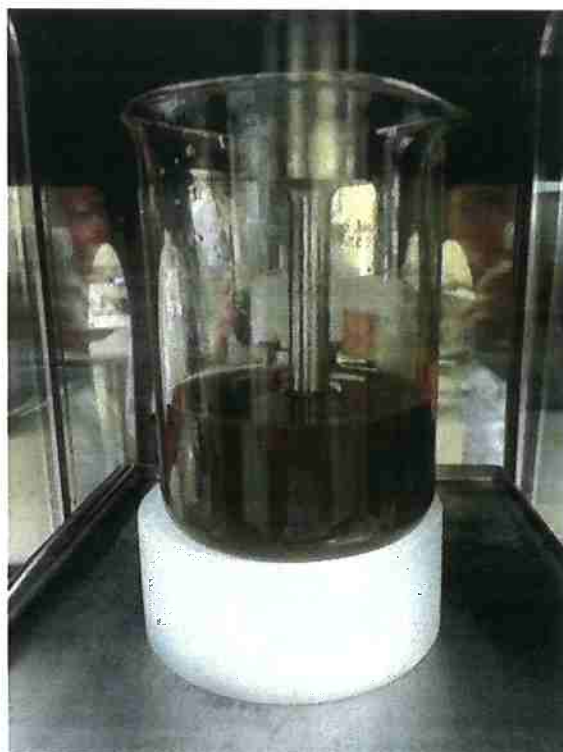
Figura 7: Solução de GO no banho ultrassônico de alta potência
