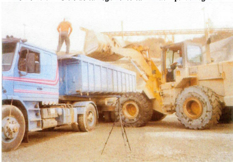
FOTO 8.1.3 – Ciclo de carregamento caminhão – pá carregadora
