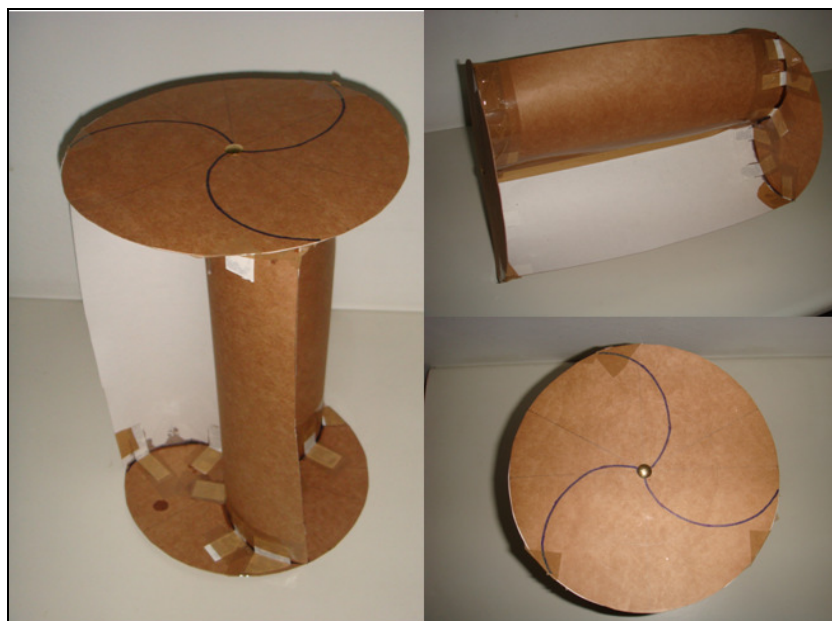
Figura 10.1 – Fotos do modelo construído em papel cartonado do rotor eólico definido no projeto.
