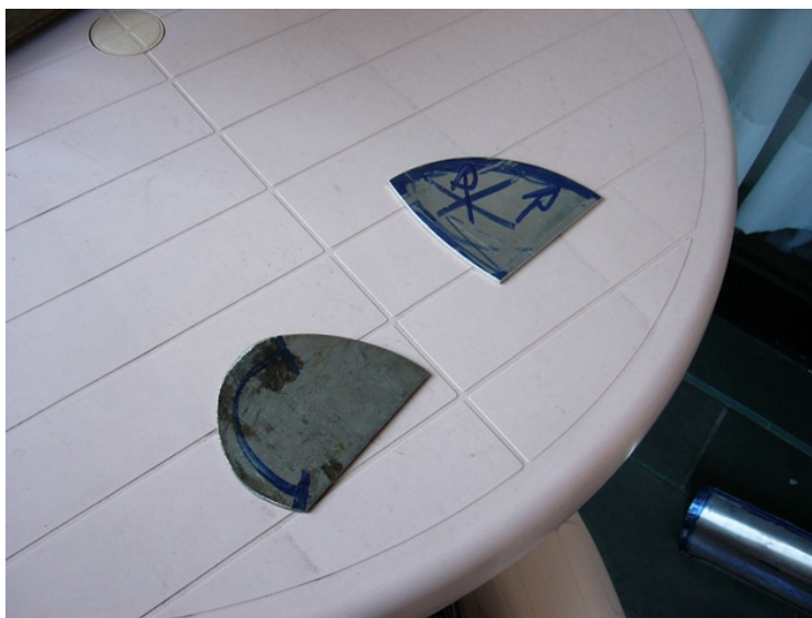
Figura 11.4 – Gabaritos utilizados como moldes das pás.
