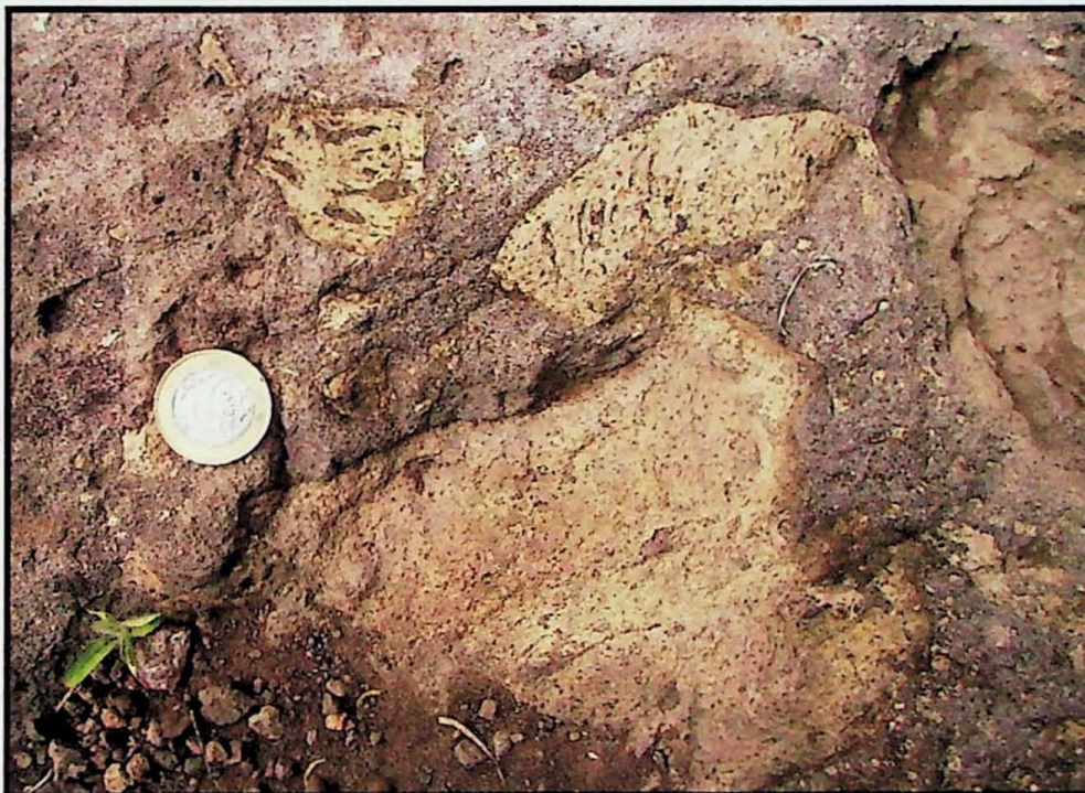
Figura 11 - Aglomerado vulcânico com clastos de riolito em matriz andesítica. BDL – 167 (UTM 22J – 239847x6617362).
