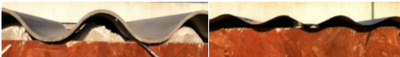
Figura 23: Ondulação das telhas conjunto 1 e 2, respectivamente.
