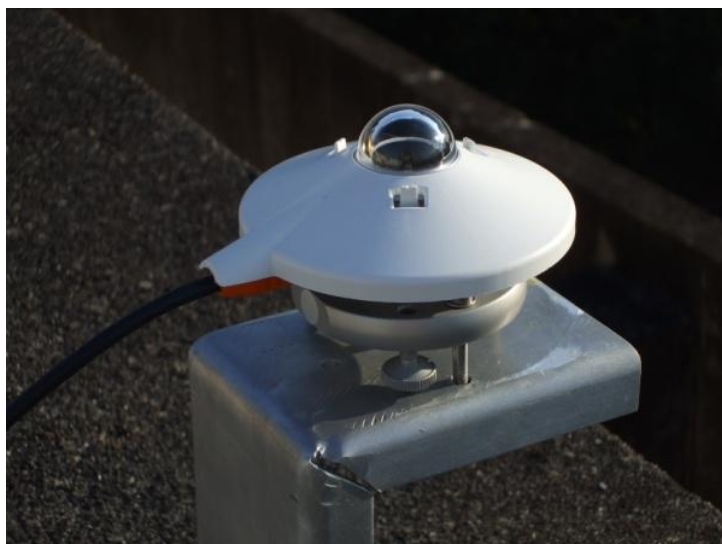
Figura 31: Radiômetro (modelo CMP3).
