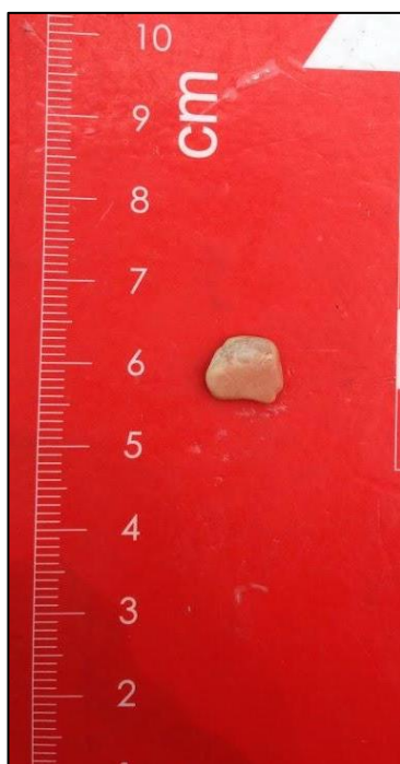
Foto 8 Fragmento de rocha rica em ferro. Chamada regionalmente pelos garimpeiros como caco de telha , devido a sua coloração avermelhada. Este fragmento de rocha é um geoindicador. Para os garimpeiros essa rocha serve como informação para indicar a presença de diamantes. Rocha encontrada próxima ao leito do Rio Capivara.
