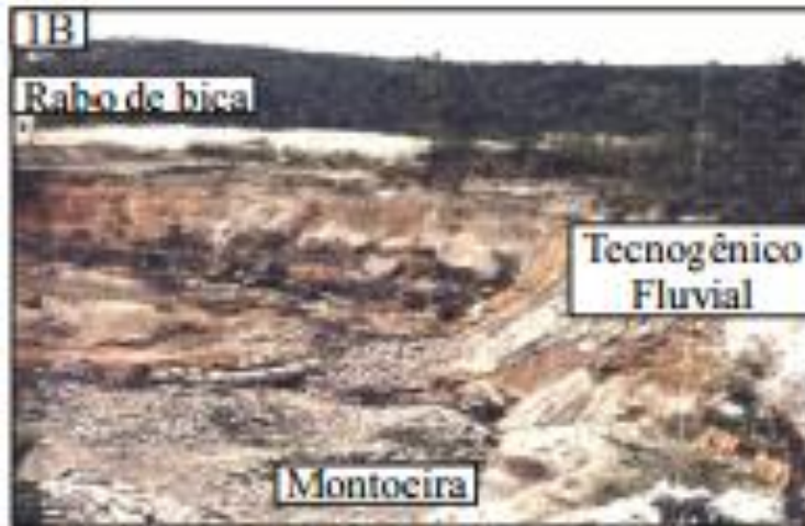
Foto 12 Processo de ampliação da Catra e formação do despejo (rabo de bica na foto) (retirada de NOLASCO (2002), pág. 141)
